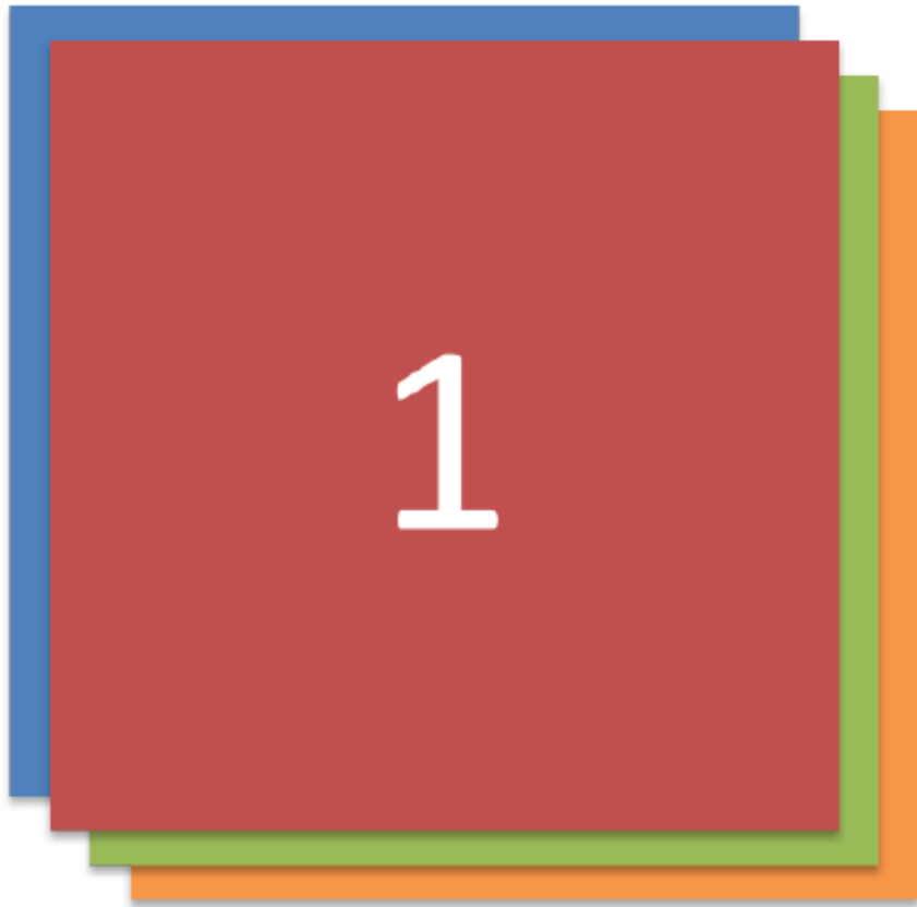
图三十二: QStackedLayout , 可以选择第二个 (图中标号为1) 控件并将其置于最前面。
