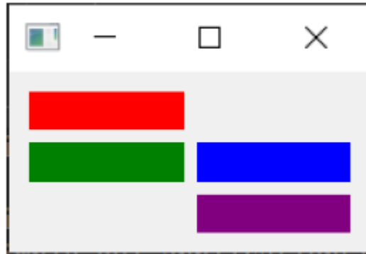
图三十：在一个 QGridLayout 的四个 Color 控件
