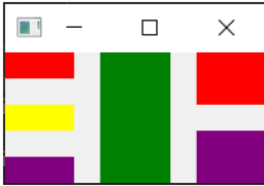
图二十七：嵌套的 QHBoxLayout 和 QVBoxLayout 布局，在控件周围留有间距和边距
