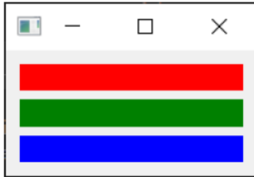
图二十三：三个 Color 控件在一个 QVBoxLayout 布局中垂直排列
