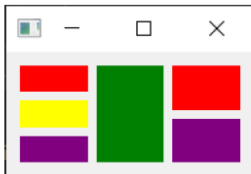
图二十六：嵌套的 QHBoxLayout 和 QVBoxLayout 布局。
